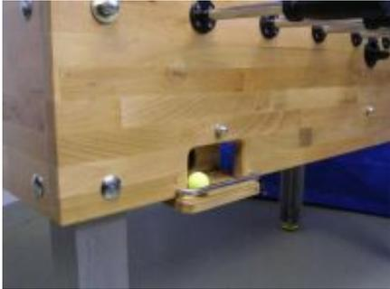
Bei Leimholz werden massive Bretter in Leisten zerschnitten und die einzelnen Leisten gegeneinander gedreht wieder miteinander verleimt. Damit soll das Arbeiten des gewachsenen Holzes bis zu einem gewissen Punkt ausgeglichen werden. Leimholz aus weichen Holzarten wie Fichte oder Kiefer ist für den Kickerbau ohne weitere Beschichtungen zu weich, Buche-Leimholz dagegen ist sehr hart. Vorteile von Leimholz:
