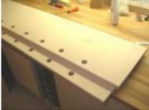
Auf dieser Seite geht es um den Rohbau der Seitenteile bis zu dem Punkt, an dem die Position der Torkästen auf den Seitenteilen festgelegt werden kann. Im ersten Schritt sind dazu die Löcher für die Stangenlager zu fräsen. Zweiter Schritt: Nach dem Baukonzept wird die Bande im Spielfeldbereich mit einem 8 mm starken Laminat beklebt - diese Verstärkung der Seitenwand ist im Bereich der Torkästen fortzuführen, um eine überall gleich starke Seitenwand ohne Versprünge zu erhalten.
