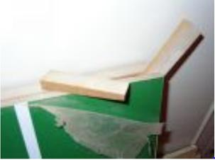
Im vierten Schritt werden die Ecken angehoben. Die Eckenanhebung soll etwa 1 cm stark sein. Wir schneiden also aus einem Holzrest oder einem Stückchen MDF Keile, die an der höchsten Stelle 1 cm hoch sind und dann im Winkel ungefähr der Neigung der fertigen Ecke entsprechen. Wie die Keilform genau auszusehen hat, kann man ausmessen. Die Keile werden in den Ecken zwischen Spielfeld und Trägerplatte geschoben und verleimt - ich habe dafür wieder Holzleim verwendet.
