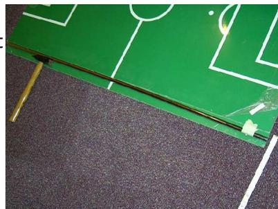
Abbildung 2: Die Nachmessung zeigt, welche bleibende Krümmung durch den Test verursacht wurde
