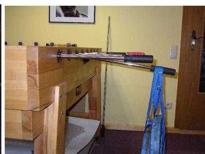
Abbildung 5: So verbiegt sich eine Kickerstange bei einer Belastung mit 40 kg Gewicht
