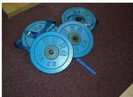
Abbildung 3: Hilfsmittel: zwei Hantelscheiben mit je 20 kg und zwei Scheiben mit je 15 kg Gewicht
