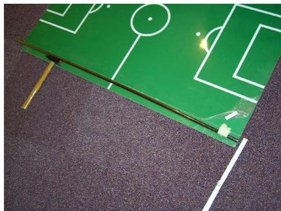
Abbildung 8: Einige der Stangen im Test waren mit bleibenden Verkrümmungen weit jenseits der 10-mm-Marke unspielbar verkrümmt
