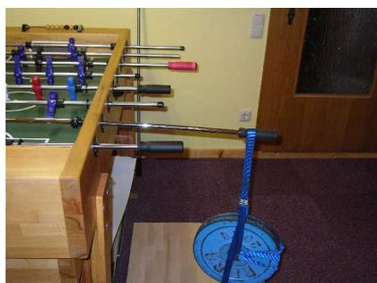
Abbildung 4: Die Belastung mit 20 kg Gewicht führt zu moderaten Krümmungen
