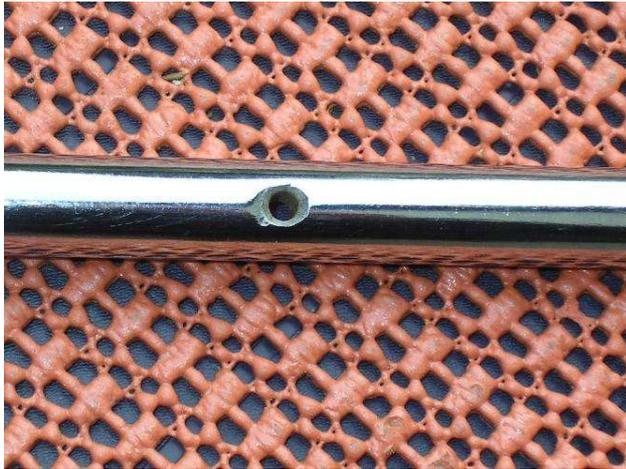
*Abbildung 9: Billige Stange: Trichterförmige Zuführung zur Bohrung; unten links ist am Rand der Bohrung eine zweite Ansetzung des Bohrers zu erkennen*
