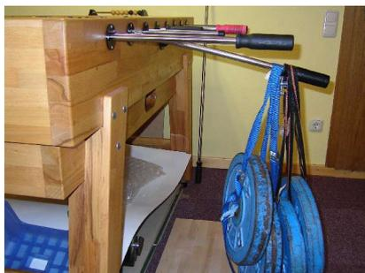
Abbildung 6: So sieht es aus, wenn 70 kg Gewicht an einer (guten) Kickerstange zerren
