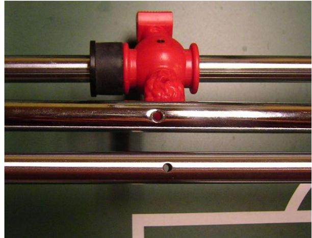
*Abbildung 10: In der Mitte eine hochglänzende Billigstange mit unsauberer Bohrung und unreiner Oberfläche; oben und unten nachgeschliffene Markenstangen mit etwas matter Oberfläche und sauberer Bohrung*
