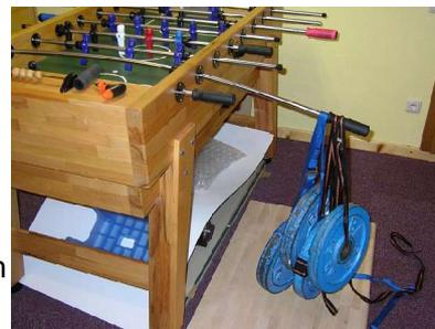
Abbildung 1: Contus-L4-Stange unter Belastung mit 70 kg Gewicht
